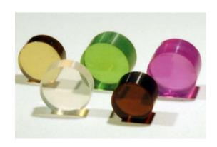
入舩センター長らのグループは、通常の焼結法 と比べてはるかに高い 10 万気圧以上の超高圧と、 1400℃程度の温度を加えることにより、透明ナノ セラミックスの一種である「透明ナノ多結晶ガー
